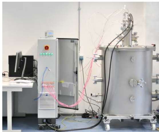
Abbildung 6: Vakuumkammer des Prüfstands zur kalorimetrischen Messung des Emissionsgrades von Rohrproben
