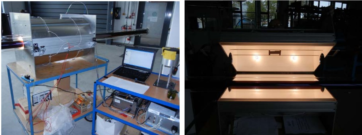
Abbildung 5: Messaufbau zur zerstörungsfreien Bestimmung des solaren Absorptionsgrades von selektiven Beschichtungen von Parabolrinnenreceivern am Fraunhofer ISE im geschlossenen Zustand (links) und geöffnet mit Blick in den integrierenden Zylinder hinein (rechts)
